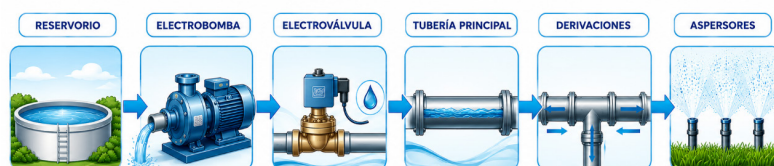
Figura 2.10. Esquema general del funcionamiento de la red hidráulica del sistema de riego automatizado.
