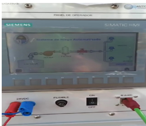
Figura 3.32. HMI KTP700 Basic de 7".
