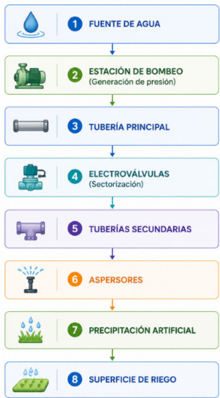
Figura 1.3. Principio de funcionamiento de un sistema de riego por aspersión.
